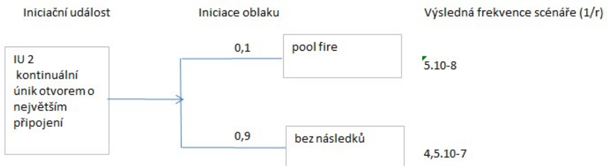
Obrázek 7: scénář SC 1, SC 3 a SC 5 kontinuální únik z ŽC/AC na Vlečce, Depu AC a čerpací stanici APH
